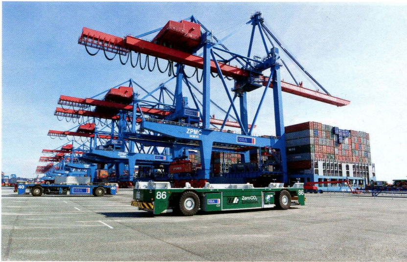
▲ Abb. 3: Den Containertransport in Altenwerder erledigen selbstfahrende AGV (Automated Guided Vehicle). Einige fahren bereits mit Batterie und ohne Emissionen.
