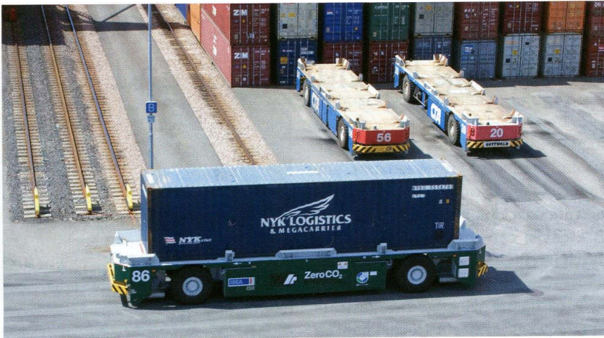
▲ Abb. 4: Neuartige selbstfahrende Batterie-AGV (Automated Guided Vehicle) werden derzeit auf dem HHLA Container Terminal Altenwerder (CTA) getestet. Weltweit gibt es keine vergleichbaren schweren Nutzfahrzeuge mit Batterieantrieb.
