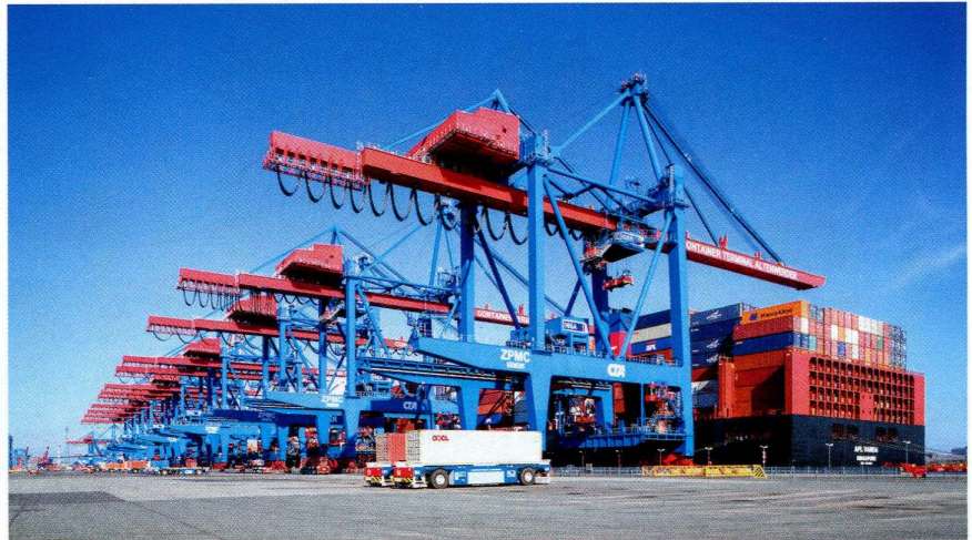
▲ Abb. 2: Am HHLA Container Terminal Altenwerder werden die Container auf batteriebetriebenen und selbstfahrenden Schwerlastfahrzeugen (Automated Guided Vehicle, kurz AGV) zu den Großschiffen transportiert.
