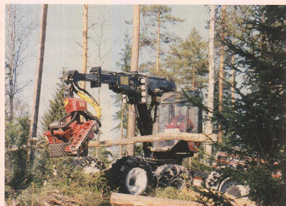
Mit diesen Erntemaschinen werden die Bäume in einem Arbeitsgang gefällt, entastet und in gleich große Stücke zerteilt.
