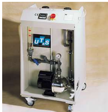
Deionisierungsanlage für die Hochleistungsdeionisierung speziell von Hartmetall. Die Anlage enthält ein Leitfähigkeitsmessgerät mit digitaler Anzeige zur kontinuierlichen Überwachung des Dielektrikums.
